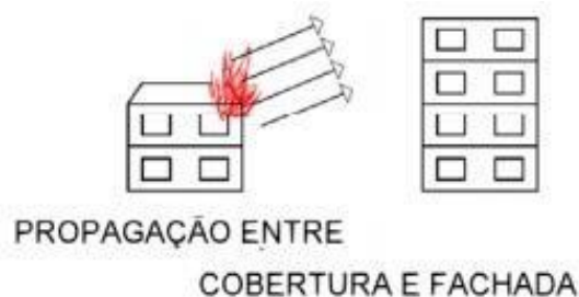
FIGURA 8 - Propagação entre cobertura e fachada.
