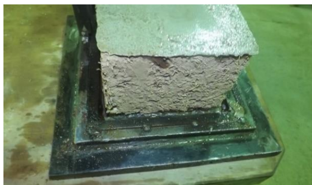
Figura 9. Forma metálica e procedimento de capeamento.
