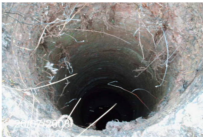
Figura 46: Buraco de sarilho visto da superfície Fonte: Foto de Wagner Muniz, 2008
