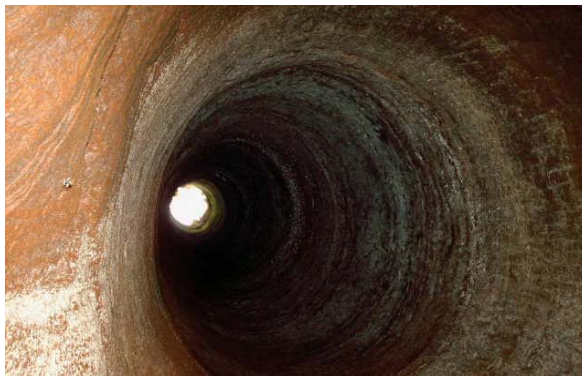
Figura 45: Buraco de sarilho visto de dentro de galeria de mineração Fonte: Foto de Wagner Muniz, 2008
