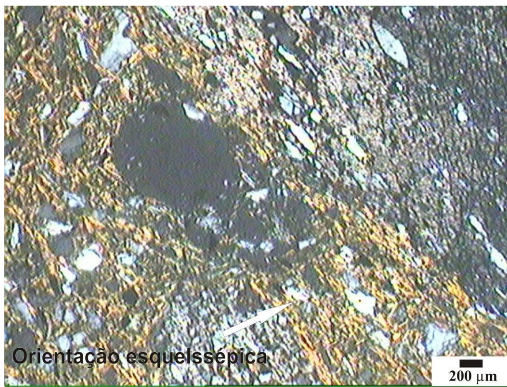
Figura 28: Fotomicrografia ao microscópio óptico (nícois cruzados) da orientação esquelssépica do plasma, envolvendo os grãos do esqueleto.
