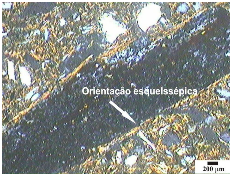
Figura 26: Fotomicrografia ao microscópio óptico (nícois cruzados) da orientação esquelssépica do plasma, envolvendo os grãos do esqueleto.
