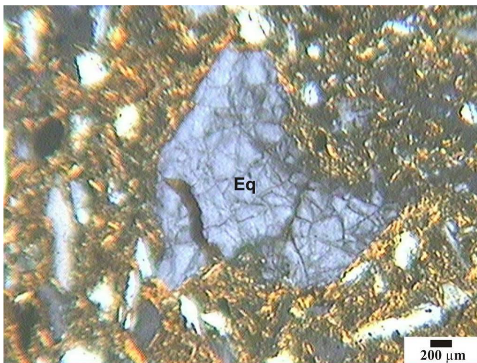
Figura 21: Fotomicrografia ao microscópio óptico (níveis cruzados) de grão de quartzo (Eq – Esqueleto de quartzo) fraturado.
