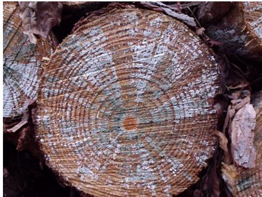
**Figura 4:** Topo de tora verde de *Pinus spp* estocada ar livre com a presença de bolor. Imagem extraída de KLOK, et al., 2005).
