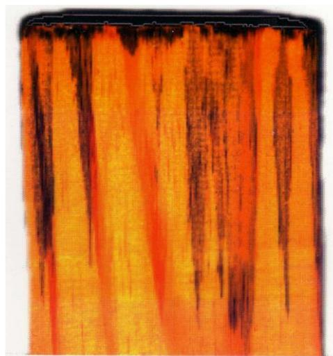
**Figura 3:** Características de madeira atacada por “fungos manchadores” - penetração pelo topo. Imagem extraída de MORESCHI, 2011.
