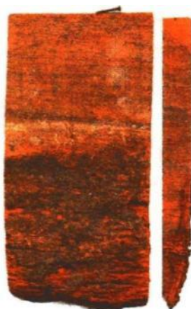
Figura 30: Fungo de podridão mole (característica do ataque frente e perfil). Fonte: http://www.ebah.com.br/content/ABAAAAMT8AH/agentes-deterioradores-madeira Acesso em: 01.03.2015
