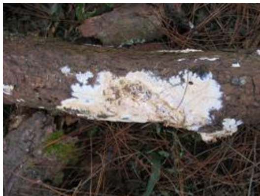
Figura 29: Madeira atacada por fungo de podridão branca. Fonte: www.embrapa.com.br ; Acesso em: 21/11/2014.
