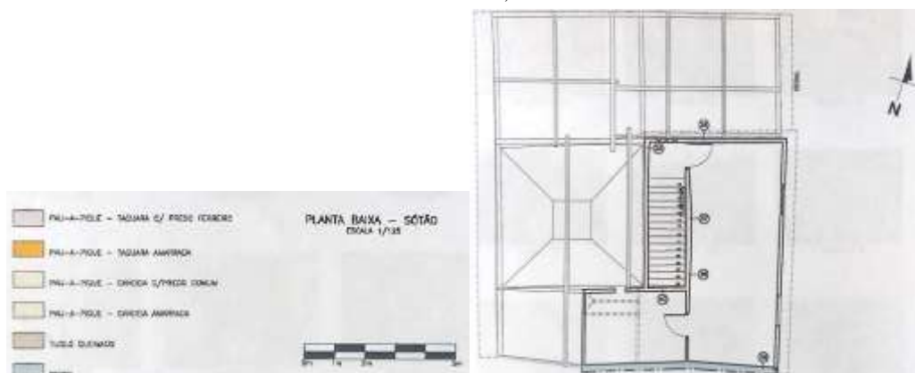
Figura 12 - Planta baixa do sótão da Casa da Baronesa, com identificação dos materiais. Fonte: IPHAN, 2000.
