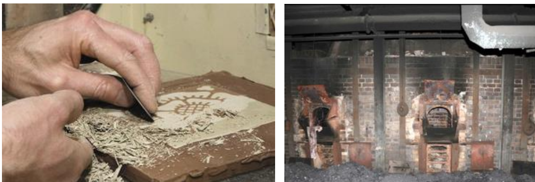
Figura 40: Remoção dos excessos da argila de preenchimento dos ornatos com uso de uma lâmina metálica.
