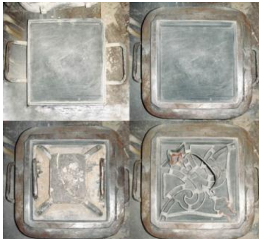
Figura 45: Diferentes partes do molde, quadrado, nomeados de Damascene. A placa ( al-šiniyyeh ), o quadro ( al-'uswārah ) e a capa ( al-ṭarbouš ), com demonstração de como o divisor pode ser configurado no molde. Fonte: < http://journals.openedition.org/abe/docannexe/image/2897/img-3.jpg >. Acesso em 05 jan. 2018.
