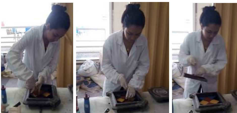
Figura 58: Primeira camada do ladrilho hidráulico (pigmento) aplicada dentro da forma.
